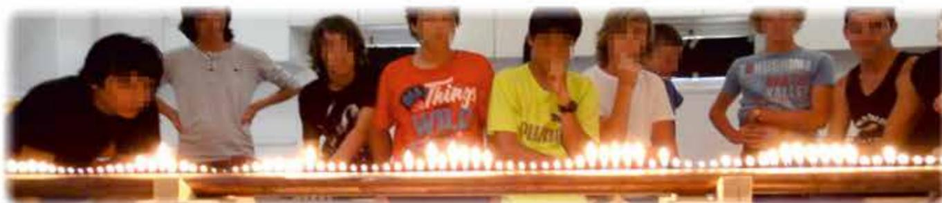
La altura de las llamas de gas muestra ondas de sonido que pasan por un tubo de cobre.
