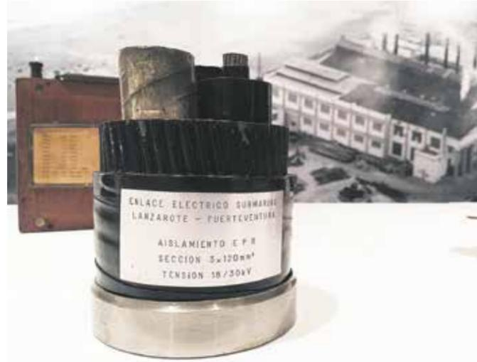
Segmento del cable eléctrico submarino entre Lanzarote y Fuerteventura.
